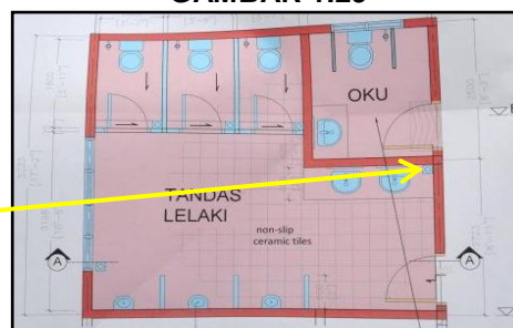
Gerai Fasa Dua, Taman Greenwood - Tiada Lubang Perangkap Lantai Dibina Seperti Dalam Lukisan Senibina (09.05.2017)
