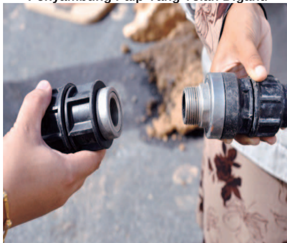
Gambar 12.6 Penyambung Paip Yang Telah Diganti
