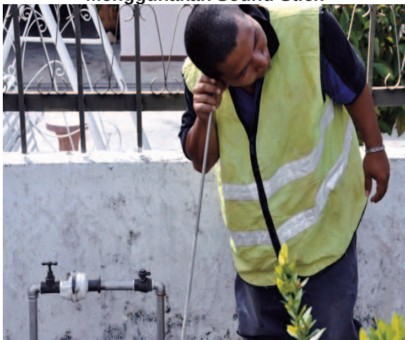
Gambar 12.3 Kaedah Pengesanan Kebocoran Menggunakan Sound Stick
