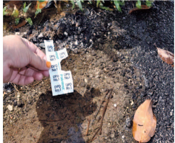
Gambar 12.2 Pengesanan Ke atas Kebocoran Kaedah Uji kaji Lopak Air
