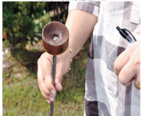
Gambar 12.4 Sound Stick Digunakan Untuk Memeriksa Tekanan Air
