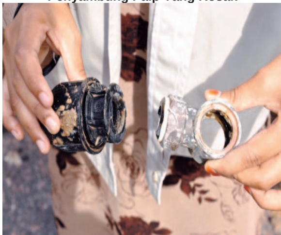
Gambar 12.5 Penyambung Paip Yang Rosak
