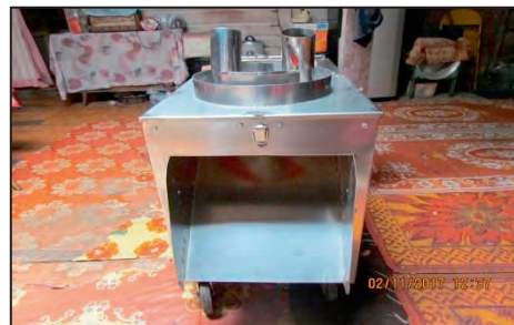
Mata Mesin Pemotong Pisang Terlalu Tebal Tidak Sesuai - Pasir Mas - Usahawan Kerepek Pisang (01.11.2017)
