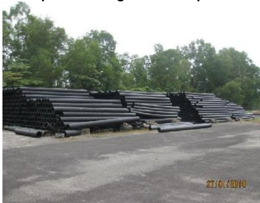
Gambar 4.8 Paip HDPE Yang Belum Dilupuskan
