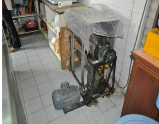
Gambar 1.8 Mesin Pengadun Roti Kotor Dan Berkarat
