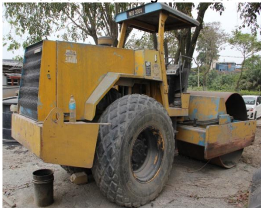
Gambar 3.8 Vibration Roller Yang Telah Rosak
