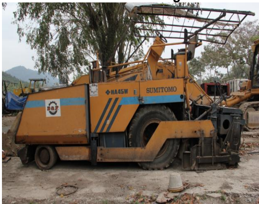
Gambar 3.5 Road Paver Sumitomo Yang Telah Rosak
