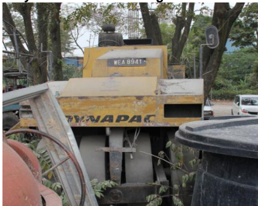
Gambar 3.6 Tyre Roller CP201 Yang Telah Rosak
