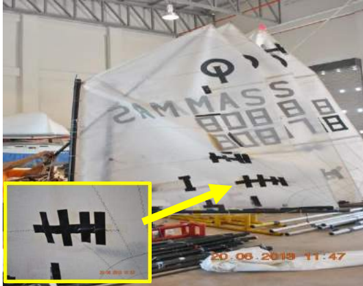
Gambar 2.40 Layar Perahu Yang Koyak Dan Ditampal
