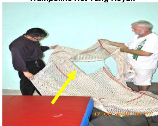
Gambar 2.36 Trampoline Net Yang Koyak
