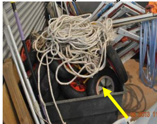
Gambar 2.43 Tayar Launching Trolley Yang Tidak Boleh Digunakan Lagi
