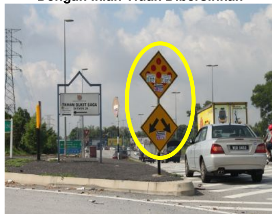
Gambar 1.12 Papan Tanda Keselamatan Yang Ditampal Dengan Iklan Tidak Dibersihkan
