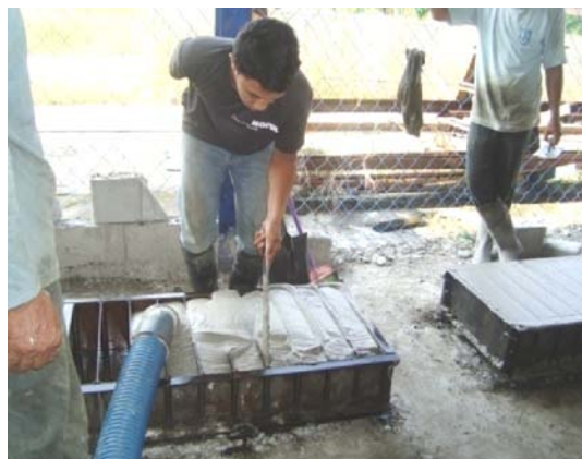
Gambar 7.7 Proses Membuat Bata
