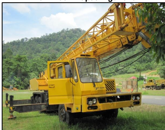
GAMBAR 13.1 Truck Mounted Mobile Crane Yang Rosak Dan Tidak Dapat Digunakan
