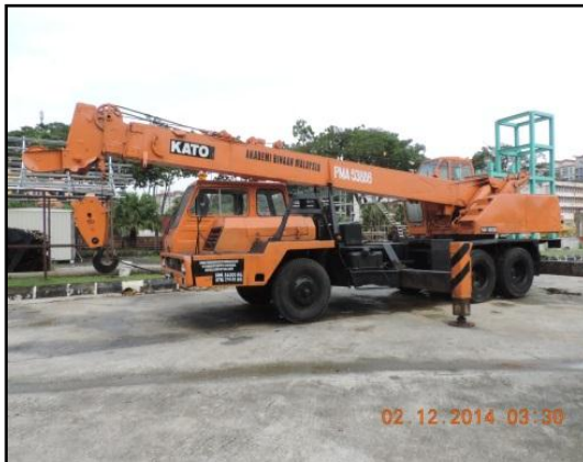
GAMBAR 13.6 Truck Mounted Mobile Crane Yang Diterima Tidak Boleh Digunakan
