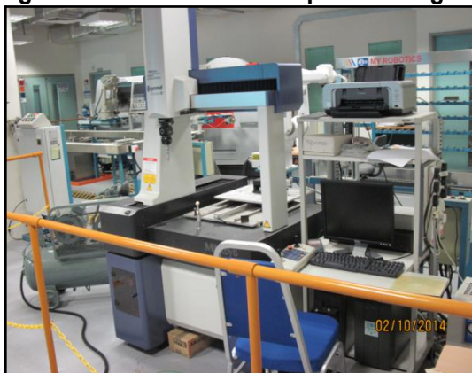
GAMBAR 8.3 Flexible Manufacturing System Yang Tidak Digunakan Kerana Tidak Dapat Berintegrasi
