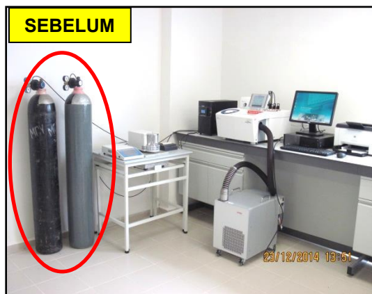
GAMBAR 6.14 Tong Gas Nitrogen dan Oksigen Yang Diletakkan Tanpa Ciri Keselamatan Bagi Peralatan Differential Scanning Calorimetry – RM195,000 (Terima 31 Disember 2013)
