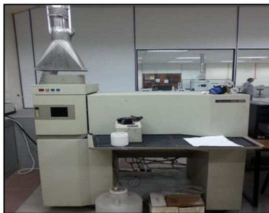
GAMBAR 5.21 Inductively Couple Plasma (ICP) Yang Rosak - RM499,247
