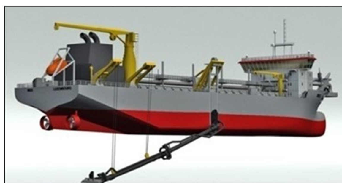
Gambar 1 : Contoh kapal korek trailing suction hopper dredger (TSHD).
